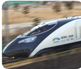
최고속도 430km/h 고속열차 동력분산형 추진시스템 적용 (세계 4번째 최고속도 421km/h 달성)
