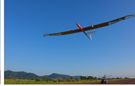
▲ 성층권 태양광 무인기 (EAV-3)53시간 연속비행 성공
